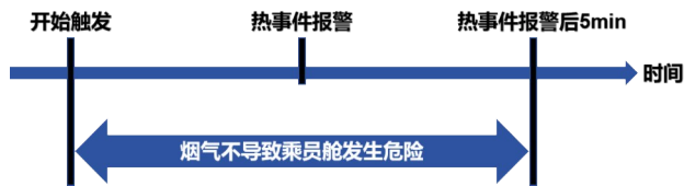
图 5 烟气危害要求 Fig. 5 smoke hazard requirements
